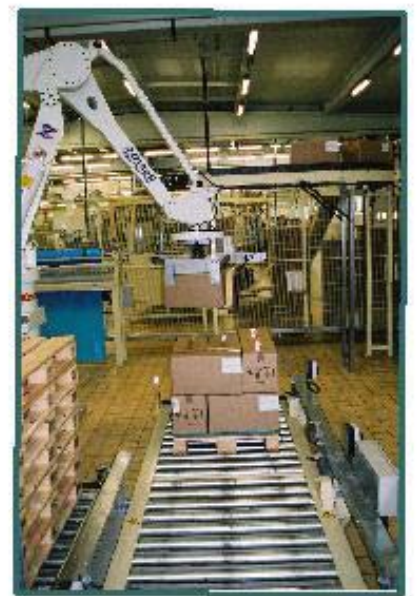
Robot pakt dozen, pallets en vellen.
